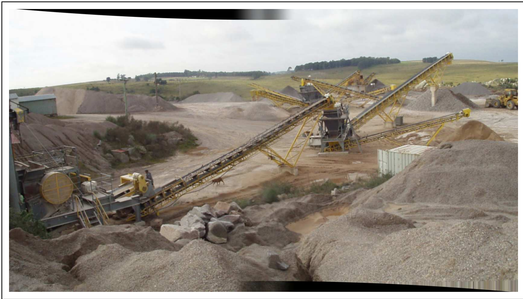
Figura 7 : Vista general de una planta típica de trituración de piedra. En primer plano a la izquierda de la foto, se ubica la entrada al circuito de la piedra en bruto a través en este caso de una mandíbula. Posteriormente la piedra partida va siendo conducida por medio de cintas transportadoras hacia zarandas vibratorias y un molinos secundarios (en este caso un trompo). El resultado es una serie de pilas de material con diferente calibración.
