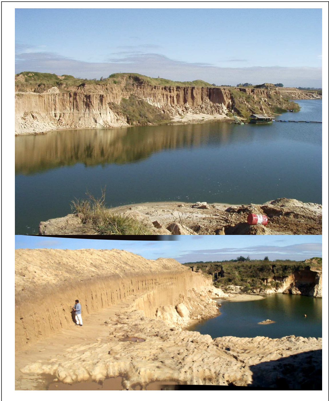
Figura 16 : En la foto superior se muestra una vista panorámica del frente de una cantera de arena en el Area 3. Notesé la dimensión importante de la labor minera y la verticalidad del frente. La draga que esta posicionada en la zona de extracción actual envía material hacia la zona de acopio (ver Figura 14-superior). En la imagen inferior se muestra la cobertura superior (F. Dolores) que ya ha sido apartada y por debajo del Geólogo el nivel arenoso a explotar, con gran cantidad de limo en los primeros metros.
