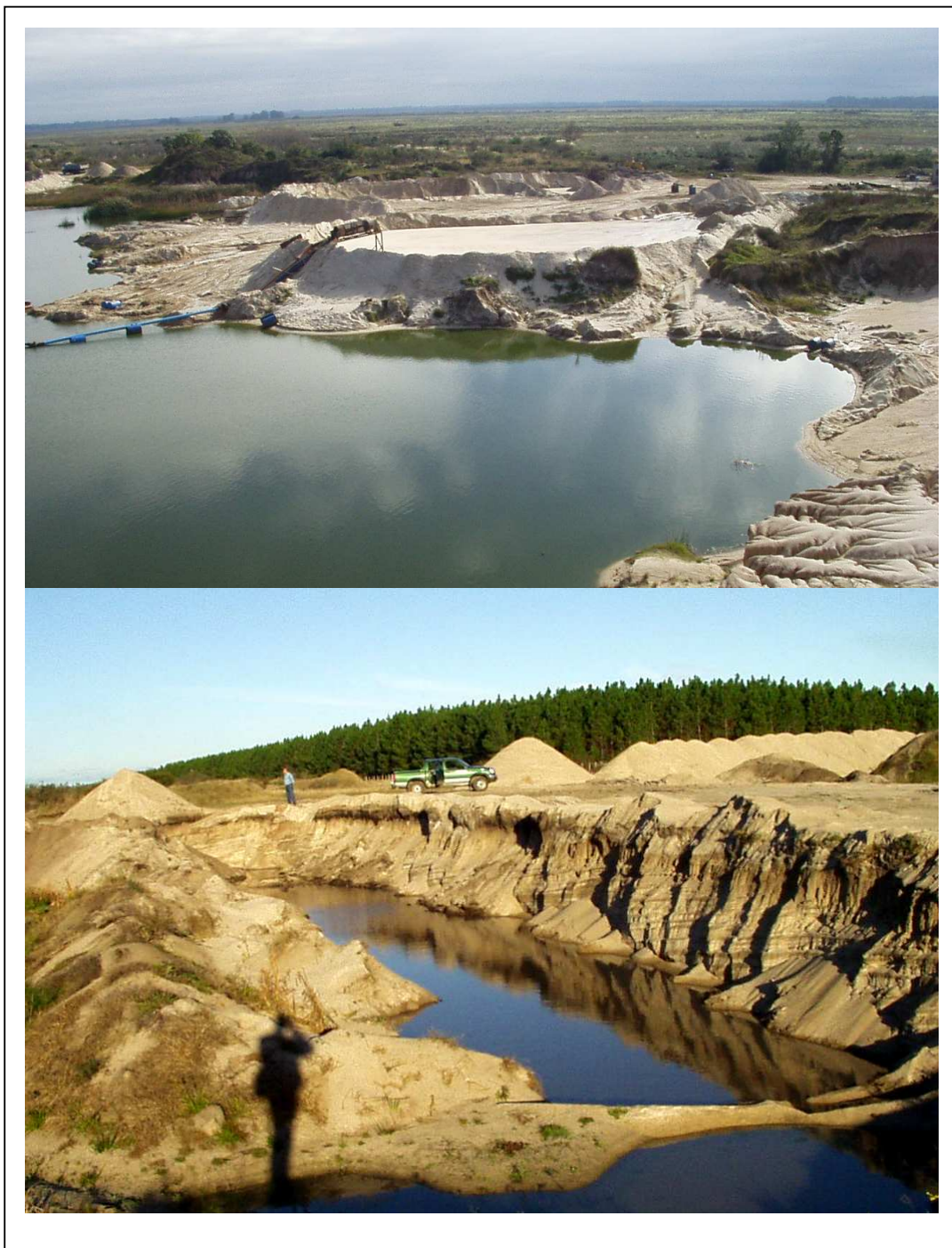
Figura 14 : En la foto superior se muestra una típica “pileta” de arena en proceso de llenado, con material que llega desde la draga(ver Figura 16-superior) a través del ducto azul . En la foto inferior se muestra una pequeña cantera abierta en las barras arenosas de la planicie del río Santa Lucía. En este caso el material se extrae directamente con retroexcavadora.
