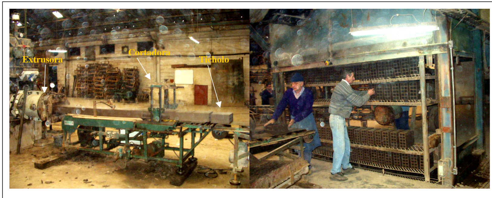
Figura 47 : En la foto de la izquierda se muestra la extrusión del material previamente preparado, y la formación de un “chorizo” de arcilla y el cortado de las piezas, en este caso ceramicas huecas(ticholos). A la derecha se muestra un secador continuo, en etapa de cargado de las piezas humedas.
