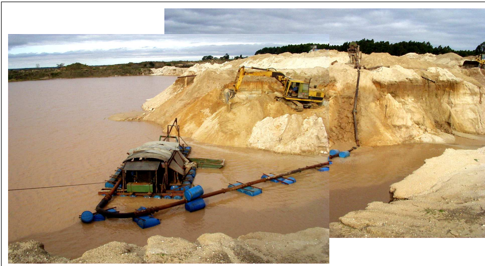
Figura 19 : Metodología de extracción de arena en la zona de Rincón de la Bolsa. La retroexcavadora desagrega el material que naturalmente es relativamente tenaz debido a la presencia de una matriz limosa. Posteriormente la draga succiona el material desmoronado y manda arena+agua por los ductos hacia la “pileta”, previo pasaje por la zaranda cilíndrica mostrada en la parte superior derecha de la imagen. Obsérvese el color marrón del agua, producto de la gran cantidad de finos en suspensión, que dificulta la operación de lavado de la arena.
