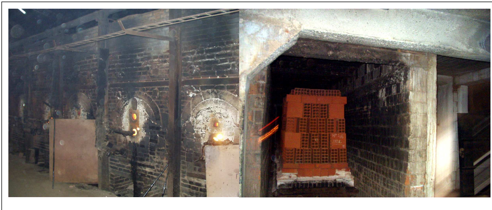
Figura 48 : A la izquierda los quemadores del horno, en la zona de máxima temperatura del mismo. A la derecha “chata” con piezas de cerámicas huecas cocidas, que han circulado a lo largo del horno y ahora están en la zona de enfriamiento del túnel.
