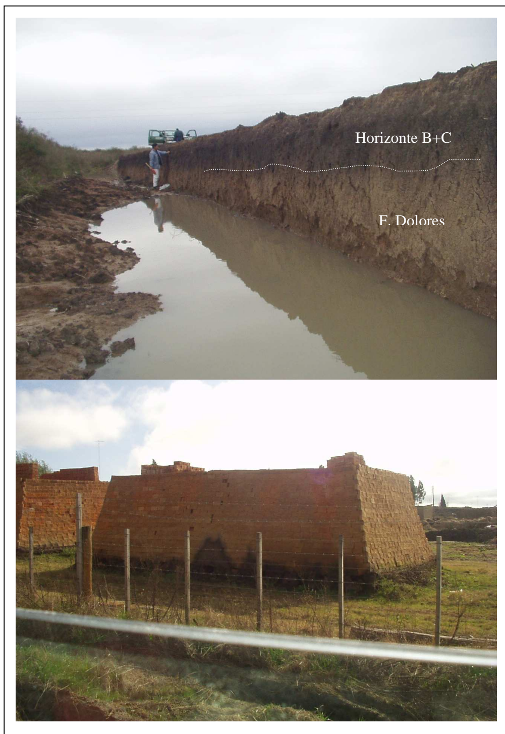
Figura 3 : Foto superior perfil de la cantera para la elaboración de cerámica roja (Cerámica San José). El material de la parte superior más oscuro se corresponde con el horizonte B+C y el material de la zona inferior, marrón claro pertenece a la Formación Dolores. En la imagen inferior típico horno de ladrillera de campo, ya “quemado” en etapa de desarmado. Obsérvese la coloración oscura en la base, producto de las altas temperaturas de quemado de esa zona y que produce piezas defectuosas.
