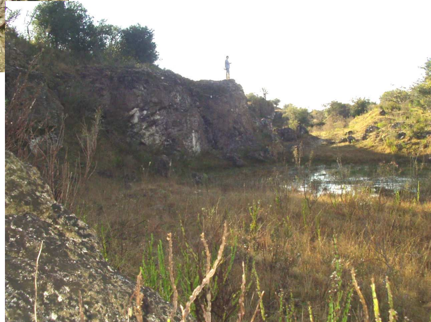
Figura 34 : Vista parcial del frente de cantera para extracción de calizas. La misma está formada por un único frente de 2 a 4 m de altura y largo de 180 m.
