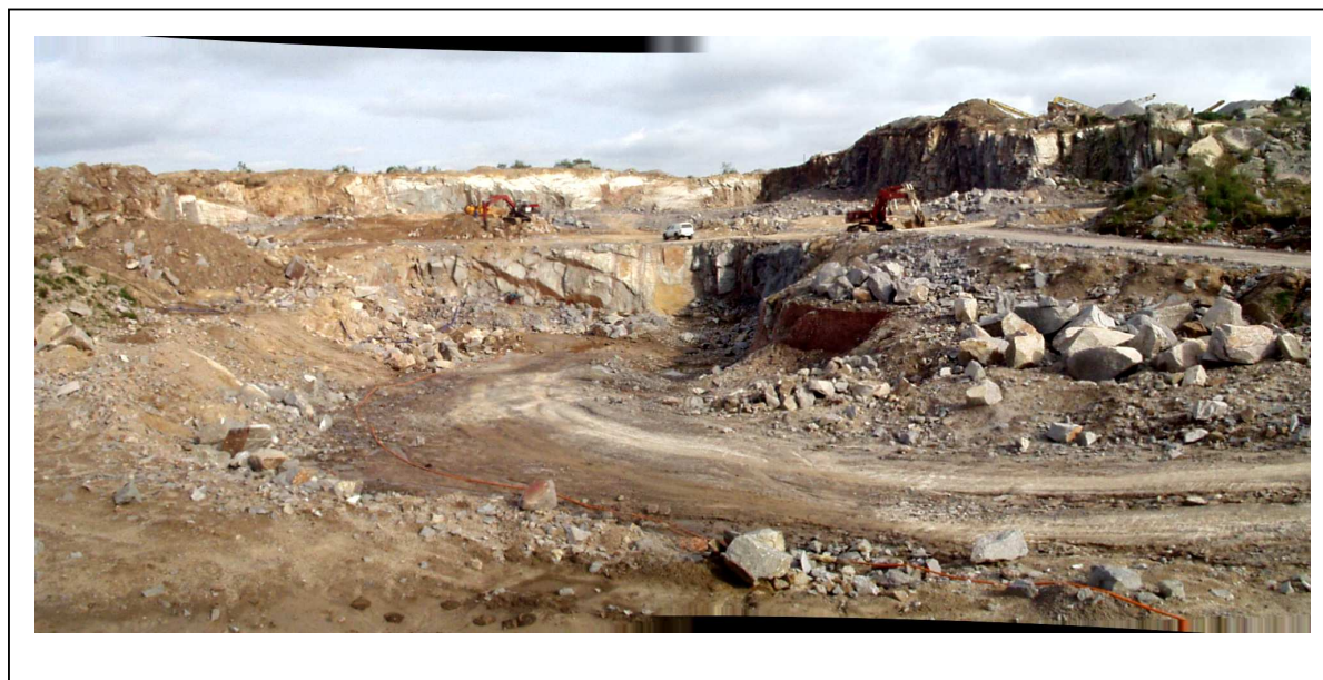
Figura 6 : Cantera de piedra partida sobre el granito de Mal abrigo. La labor minera está formada por dos pisos, con frentes de 4-5 m de altura cada uno.
